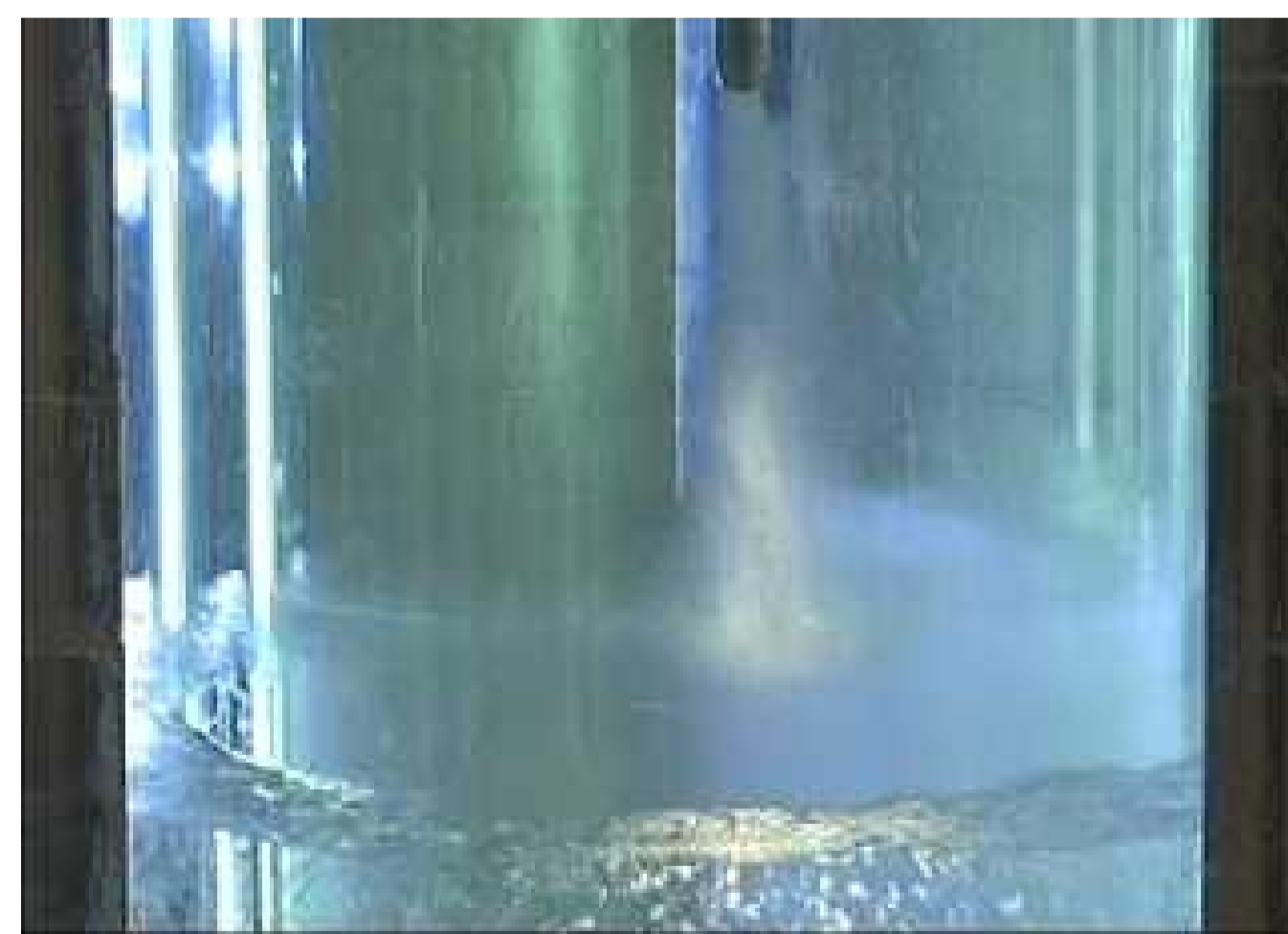
Hélium 4 liquide entouré d'un écran thermique d'azote liquide
