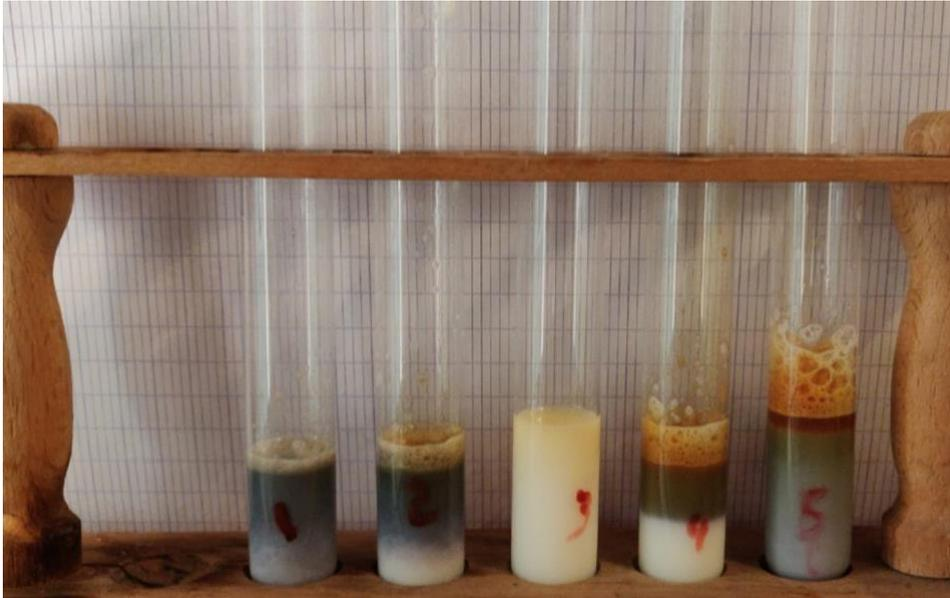
*Résultat après versement de quelques gouttes d'eau iodée dans chacun des tubes. Les tubes contaminés (les n°1, 2, 4 et 5) ressortent noirs, contrairement aux tubes non contaminés (le n°3) qui se colorent légèrement en jaune.*
