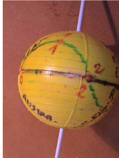
Fig. 4: Trace de l'orbite sur la Terre obtenue par les pointages successifs (0, 1, 2,...) correspondant respectivement aux instants 0, T/4 , T/2 ... On observe l'aspect « sinusoïdal » et la réduction de la période angulaire à A = 180^\circ environ. Il y a en effet un quart de période T (passage de 0 à 2) pour 90^\circ de longitude terrestre.
