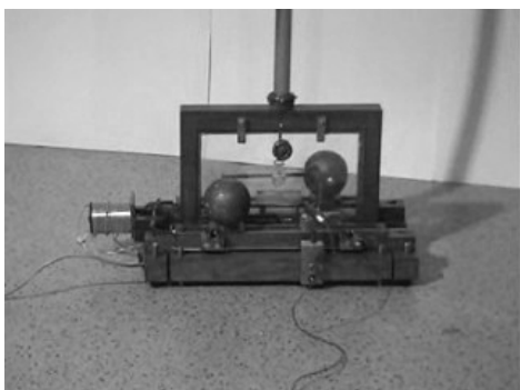
La nouvelle balance de Cavendish, entièrement automatisée.
