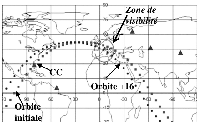
Fig. 5 : Traces des orbites +15 et +16, le lendemain d'un exemple de passage initial favorable. La zone de visibilité (hauteur 10^\circ ) est calculée pour un observateur à Toulon... On suppose ISS toujours éclairée par le soleil, mais l'observateur dans la nuit.
