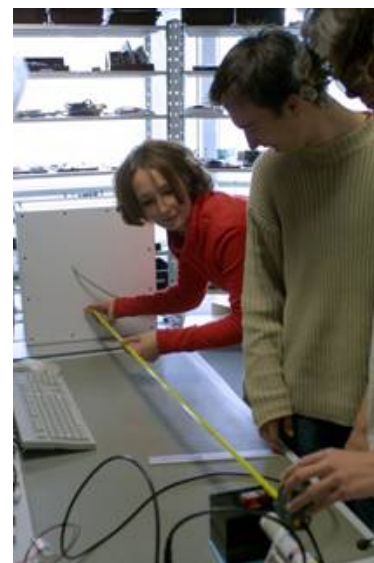
Figure 5 : Mesure de la distance entre le hacheur et le « miroir » afin de calculer, grâce à la tangente, l'angle de réfraction du faisceau lumineux qui est d'environ 1°
