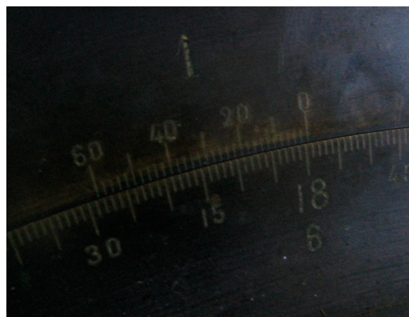
Figure 5 : Affichage de l'angle horaire. La valeur précise affichée est : 17 h 59 min 25sec. L'incertitude est de l'ordre de quelques secondes de temps, car sur le vernier les graduations en coïncidence vont de 23 à 27 secondes.
