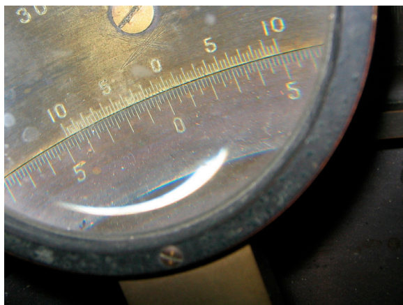
Figure 4 : Affichage de la déclinaison. La valeur affichée est : 0^{\circ} 5' 20'' à plus ou moins 40'' près.
