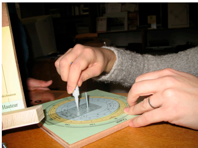
Figure 3 : Fixation du repère ascension droite - angle horaire - azimut sous le pied de la potence (gauche) et des deux réticules aux extrémités de l'alidade (droite). Vous noterez que le repère est constitué d'un vernier pour améliorer la précision de la mesure (voir l'article sur le vernier, juste après le présent article)
