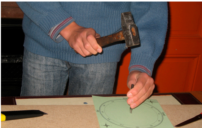
Figure 2 Découpe du cercle des azimuts à l'emporte-pièce (gauche), et fixation de la potence sur son pied (droite)
