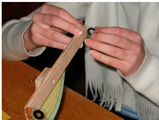
Figure 3 : Fixation du repère ascension droite - angle horaire - azimut sous le pied de la potence (gauche) et des deux réticules aux extrémités de l'alidade (droite). Vous noterez que le repère est constitué d'un vernier pour améliorer la précision de la mesure (voir l'article sur le vernier, juste après le présent article)
