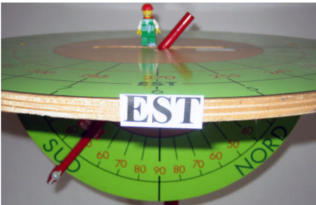
Figure 2a : Horizon de la maquette géocentrique. L'axe polaire rouge qui va recevoir la « sphère céleste » est incliné de 50° par rapport à l'horizon pour visualiser les observations d'un observateur placé à la latitude 50° Nord.
