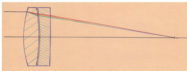
Fig. 5 La correction du chromatisme n'est pas réalisable de manière égale dans tout le spectre ; pour l'observation visuelle, on choisit la meilleure correction autour de la longueur d'onde du vert-bleu qui correspond à la sensibilité dominante en vision nocturne.
