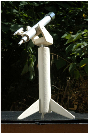
Lunette azimutale sur pied colonne : lunette d'initiation.
