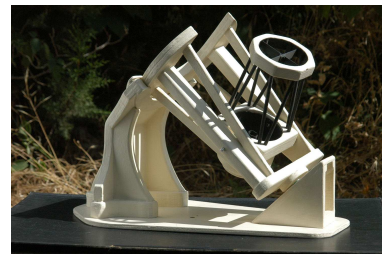
Télescope à deux piliers avec fer à cheval au nord autorisant la visée des alentours de la Polaire : le 2 m du Pic du Midi ou le 5,08 m de Palomar.
