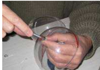
On fixe l'axe de la Terre sur la sphère céleste en intercalant des rondelles et en immobilisant les écrous par une goutte de colle (cyanoacrylate par exemple).
