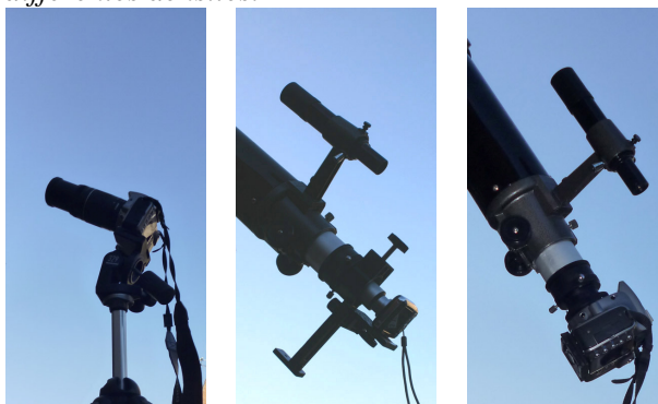
Fig.6. Trois techniques de photo pour le passage du 6 juin : 1. Téléobjectif. 2. Lunette avec appareil compact derrière oculaire. 3. Lunette sans oculaire avec boîtier reflex sans objectif. Il faudra ajouter un filtre si le Soleil est trop lumineux.
