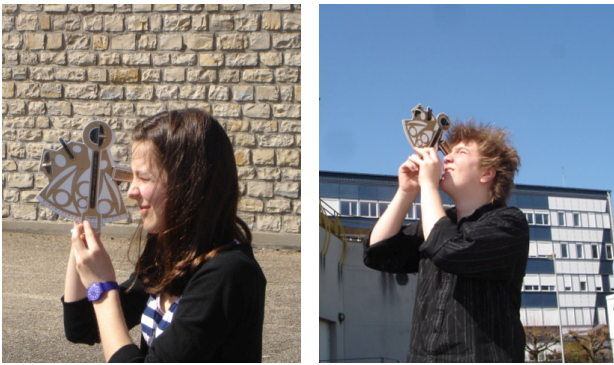
Utilisation d'un sextant pour mesurer la hauteur du Soleil.
