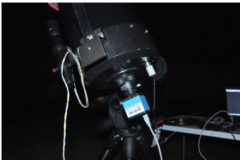
Fig.5. La caméra CCD avec les filtres, fixée sur l'oculaire du télescope.
