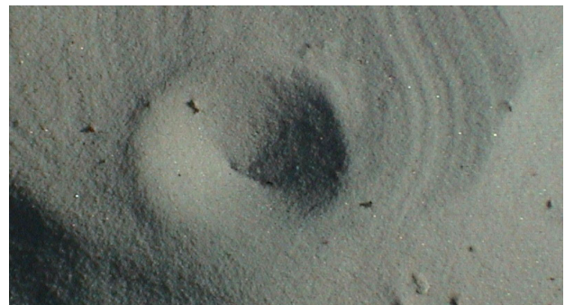
Fig.2. Impact vertical d'un boulon dans du sable fin. En faisant l'expérience, on s'aperçoit que l'angle d'incidence a peu d'influence sur la forme du cratère.
