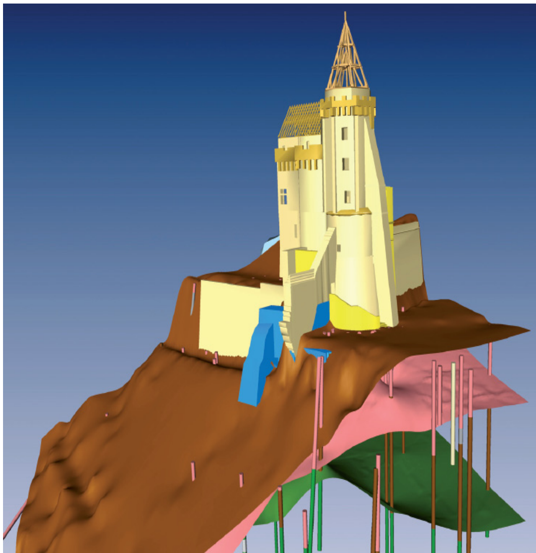
Chateau de Saumur : modèle détaillé avec les sondages, la surface topographique (brun), la surface de la base des remblais (rose), la surface de la base des sables (vert) ; en bleu, des éléments de construction apparus lors des travaux.
