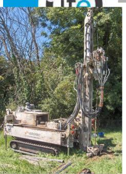
Sondeuse pour essais pressiométrique
