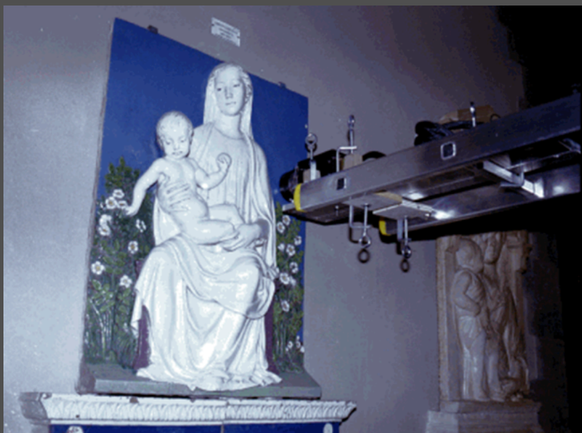
Madonna del Roseto, Luca della Robbia pendant une analyse "in situ" avec un instrument portable a-PIXE Avec la permission du Museo Nazionale del Bargello 2
