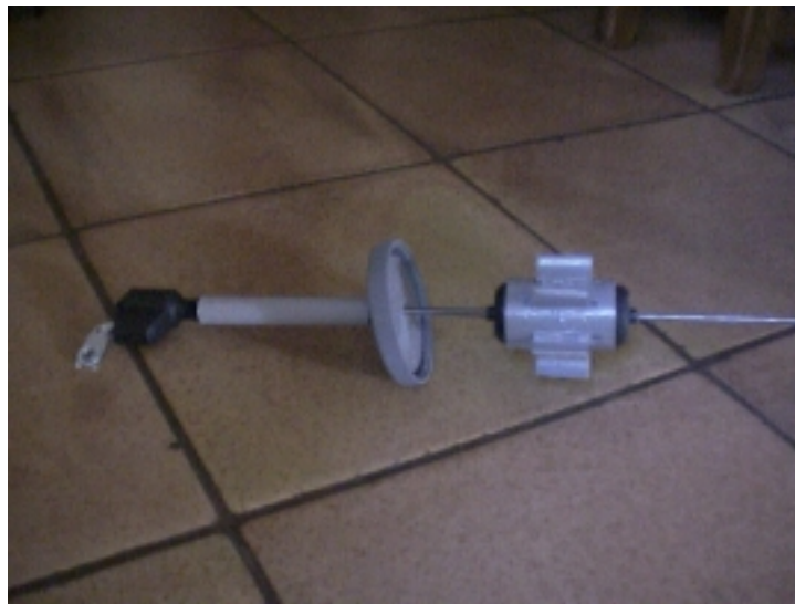
La turbine raccordée à la dynamo
