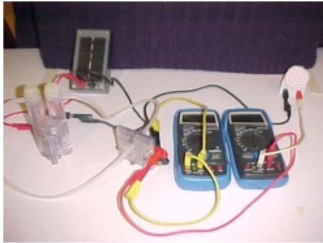
Montage pour mesurer le rendement de la pile. Source : P.J.
