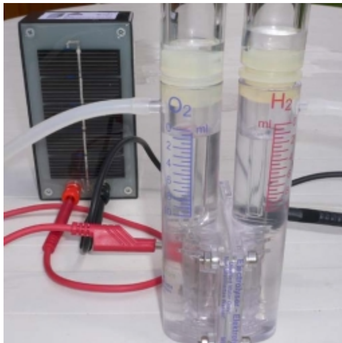
Electrolyseur pédagogique couplé à des cellules solaires.
