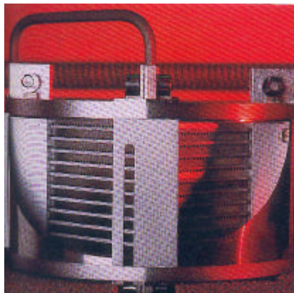
Prototype de pile SOFC réalisé au centre de recherche de Jülich en Allemagne
